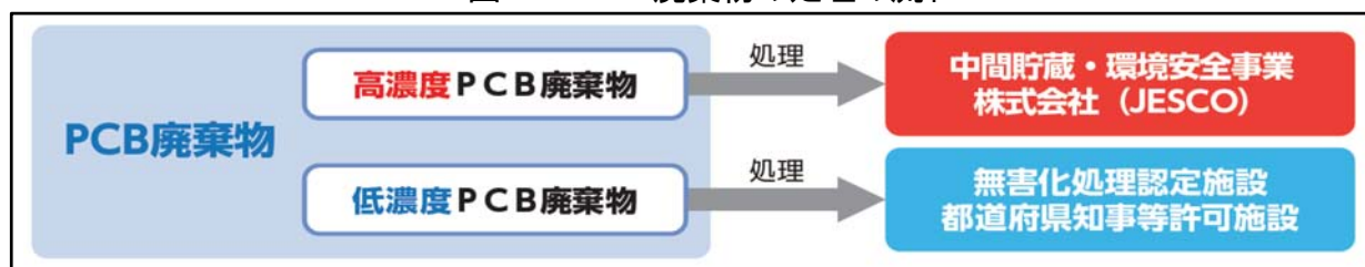
図3-7 PCB廃棄物の処理の流れ
