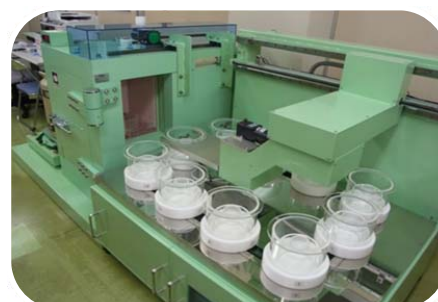
食品・液体の放射線測定機器 (二本松市内NPO法人)
